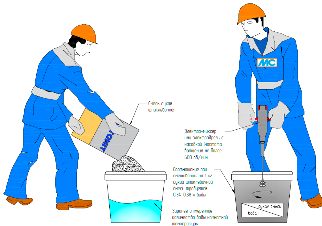
Рис. 16. Организация работ по затворению сухой шпаклевочной смеси
